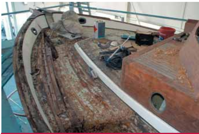
Das verrottete Deck war renovationsbedürftig.
