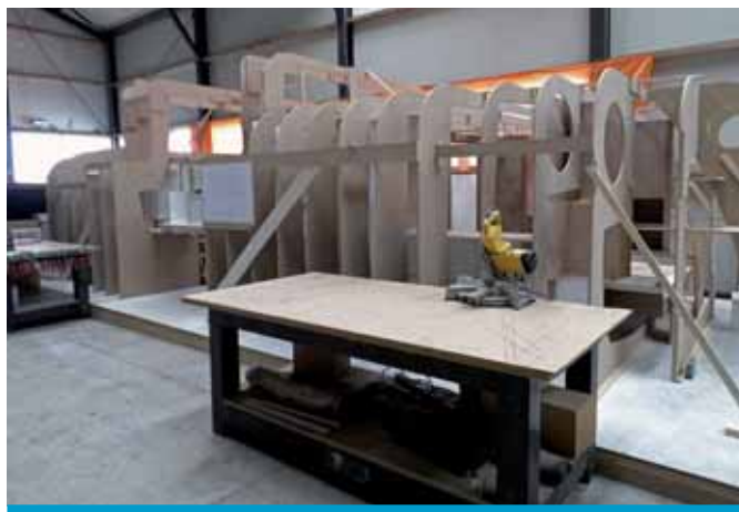
Das Interieur wird in der Werfthalle in eine 1:1 Maquette installiert. Erst wenn alles stimmt, erfolgt der Einbau in das Schiff.
